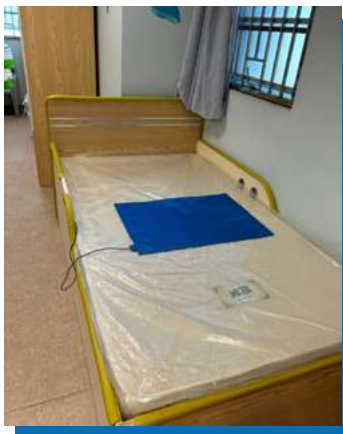
● 圖八：智能離床感應系統感應墊
