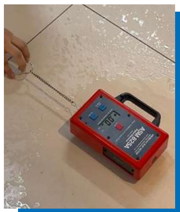
● 圖十：瓷磚地板防滑工程儀器測量防滑係數
